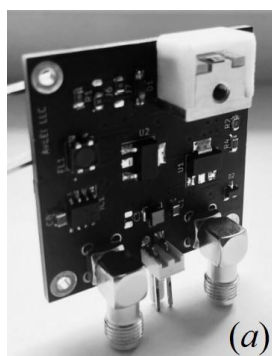
рис.1 Фотография разработанного передатчика (а); зависимость оптической мощности (1) и напряжения на синхровыходе (2) от времени (б); частотные зависимости мощности оптических импульсов при различном напряжении питания SV передатчика (в)
