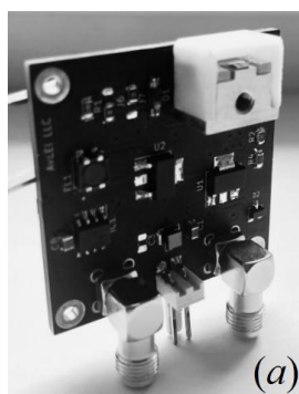
рис.1 Фотография разработанного передатчика (а); зависимость оптической мощности (1) и напряжения на синхровыходе (2) от времени (б); частотные зависимости мощности оптических импульсов при различном напряжении питания SV передатчика (в)
