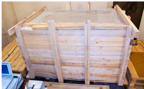
Рис. 4. Внешний вид испытательного стенда с модельной средой – увлажненным песком
